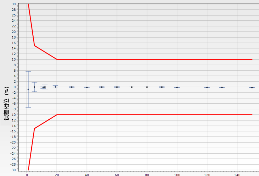
I 光学互感器振幅误差边界 — GOST 7746-2001与 IEC 60044-8-2010标准允许的0.2级误差精度边界 o 光学互感器误差幅度
